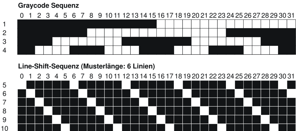
Abbildung 36: Graycode (oben) und Line-Shift-Sequenz (unten) einer fiktiven Projektionseinheit mit 32-Linien. Mit nur sechs Projektionen lässt sich bei der Subpixelmessung die ganze Auflösung des Projektors ausnützen.
