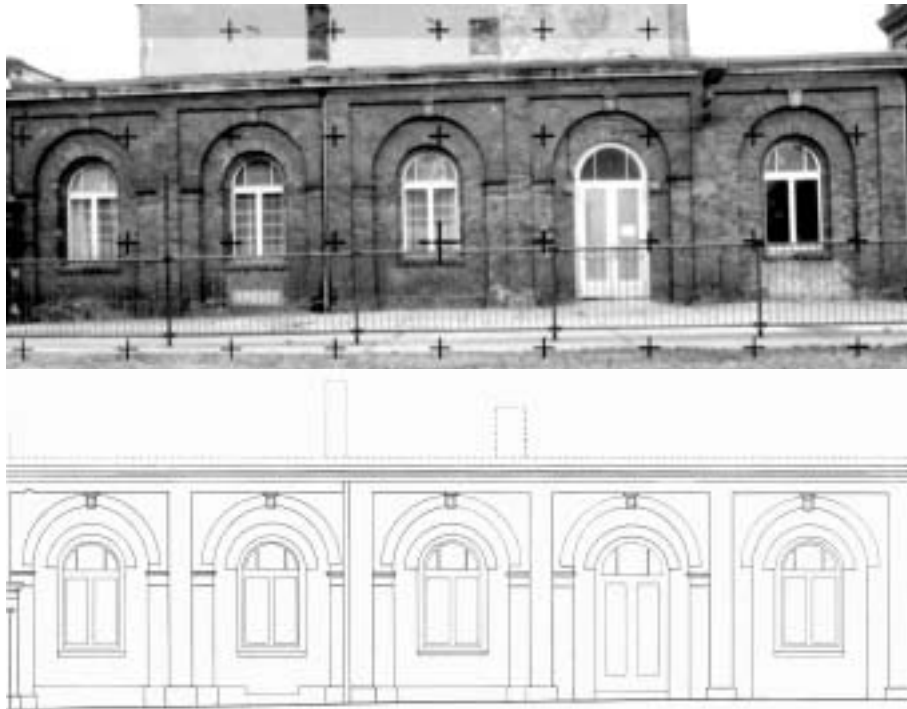
Abb. 4.13: Strukturierung und Darstellung von Bauwerksinformationen
