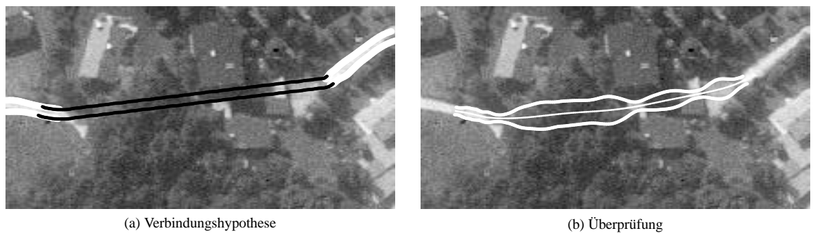
Abbildung 5.20. Beispiel für eine wegen fehlender Konstanz der Breite verworfene Verbindungshypothese
