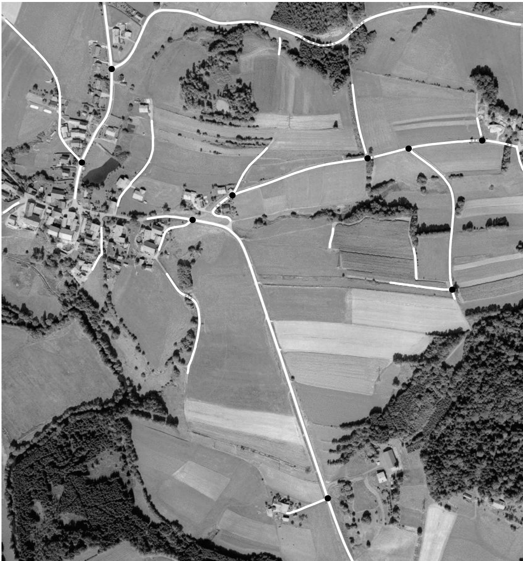
Abbildung 5.28. Extrahierte Straßen und Kreuzungen; Punktiert: Straßen, die nur auf Grund von Kontextinformation verifiziert wurden.
