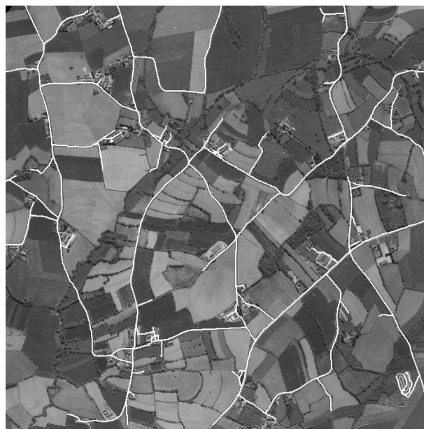
Abbildung 6.9. Datensatz III: Durch sequentielle Kombination lokaler und globaler Gruppierungskriterien extrahiertes Straßennetz
