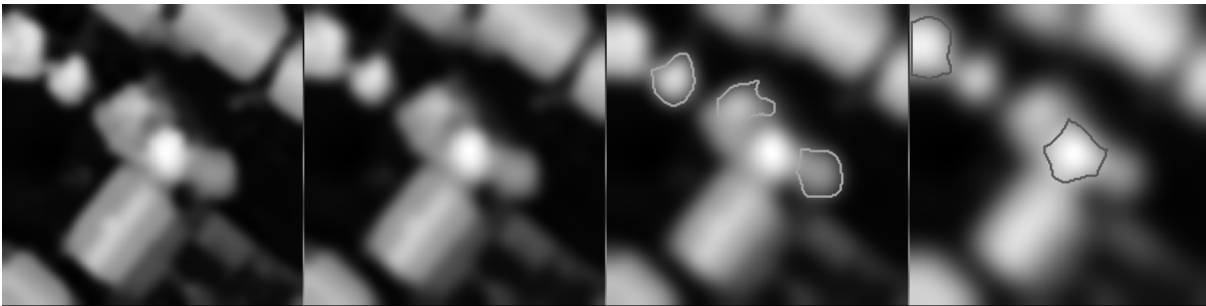
Abbildung 52: Baumhypothesen in vier unterschiedlichen Maßstabsebenen ( \sigma = 1, 2, 4, 8 [Pixel]) nach der Selektion der besten Hypothesen im Maßstabsraum (vgl. Abbildung 47 und Abbildung 51)
