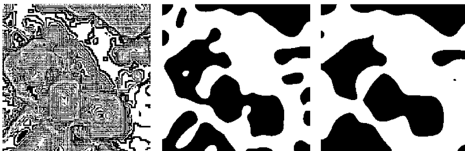
Abbildung 42: Konvexe Stellen des Höhenmodells aus dem Testdatensatz DREI-BÄUME in drei unterschiedlichen Maßstabsebenen \sigma = 0.1, 1.0, 1.4 \text{ m}
