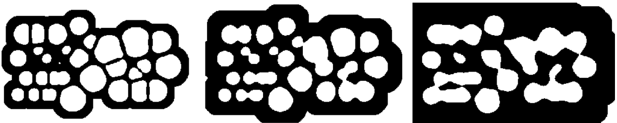
Abbildung 13: Segmentierung des Testbildes POLLOCK-BÄUME. Weiß: Summe der zweiten Ableitungen negativ. Schwarz: Summe der zweiten Ableitungen Null oder positiv. Links: \sigma=4 . Mitte: \sigma=8 . Rechts: \sigma=16 .
