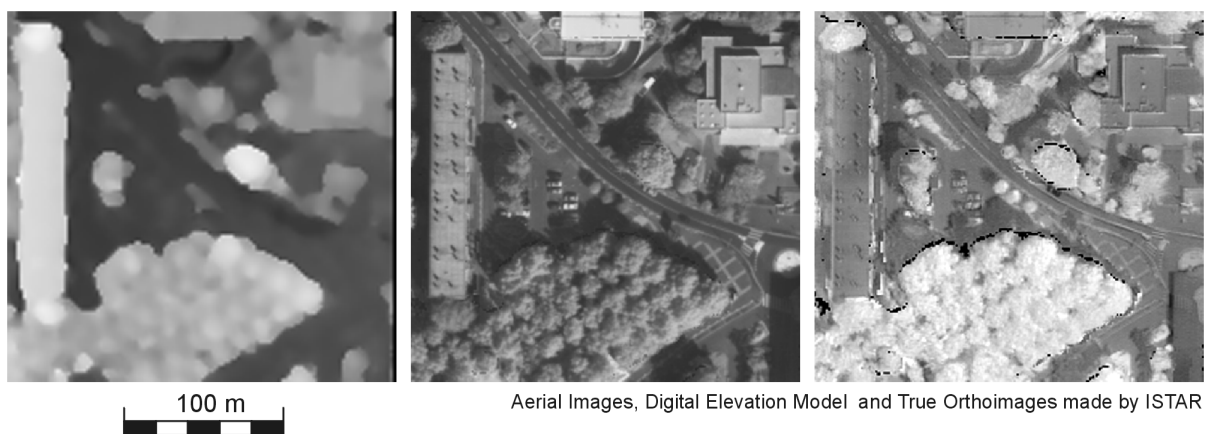
Abbildung 66: Projekt Paris. Links: Rasterförmiges Oberflächenmodell. Mitte: Intensitätskomponente des Farbinfrarotbildes. Rechts: Vegetationsindex NDVI, negative Werte sind dunkel dargestellt, positive Werte hell.
