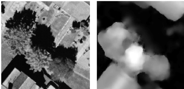
Abbildung 33: Abbildung von drei Bäumen in einem hochauflösenden Farbinfrarotbild (dargestellt ist die Intensitätskomponente) mit einer Auflösung von 0.1 m und im entsprechenden Ausschnitt aus dem Oberflächenmodell. Auf diesen Ausschnitt wird im Text mit dem Namen DREI-BÄUME Bezug genommen.
