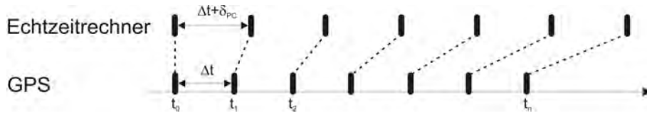
Abbildung 6.2: Drift der Uhr des Echtzeitrechners
