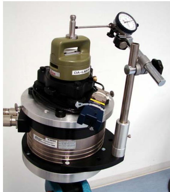
Bild 6-8: Drehmotor mit Aufnahme zur Messung der Exzentrizität
