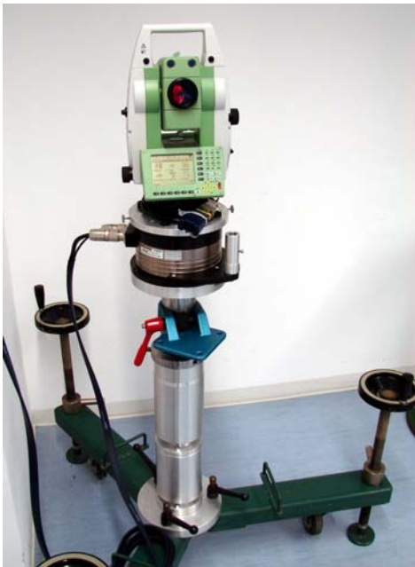
Bild 6-7: fahrbares Stativ mit Drehmotor und Prüfling (Robottachymeter)
