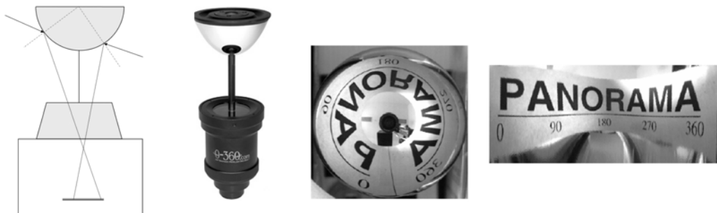
Abbildung 3.20: Aufnahmeprinzip Spiegel-Panorama, Spiegel-Spezialobjektiv, Abbildung auf dem Sensor (Originalbild), umgewandeltes 360°-Panoramabild [Svoboda & Pajdla, 2000] (v.l.n.r.)
