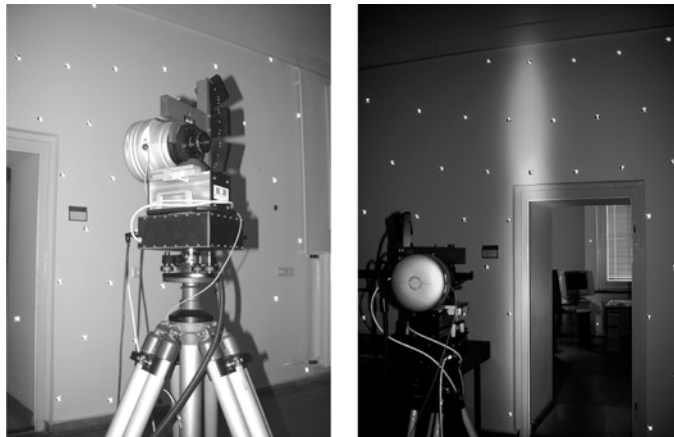
Abbildung 5.2: Panoramakamera im Kalibrierraum (links) und Streifenlichtbeleuchtung (rechts)
