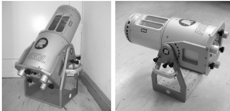
Abbildung 5.16: Terrestrischer Laserscanner im Fisheye-Kalibrierraum: um 45^\circ verschwenkt (links), um 90^\circ verschwenkt (rechts)
