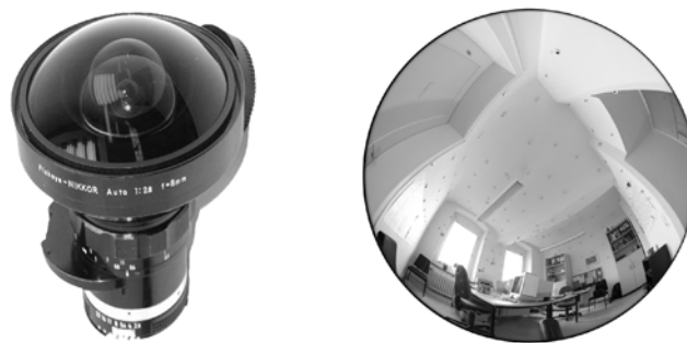
Abbildung 3.16: Fisheye-Objektiv Nikkor 8 mm (links) und Fisheye-Bild (rechts)
