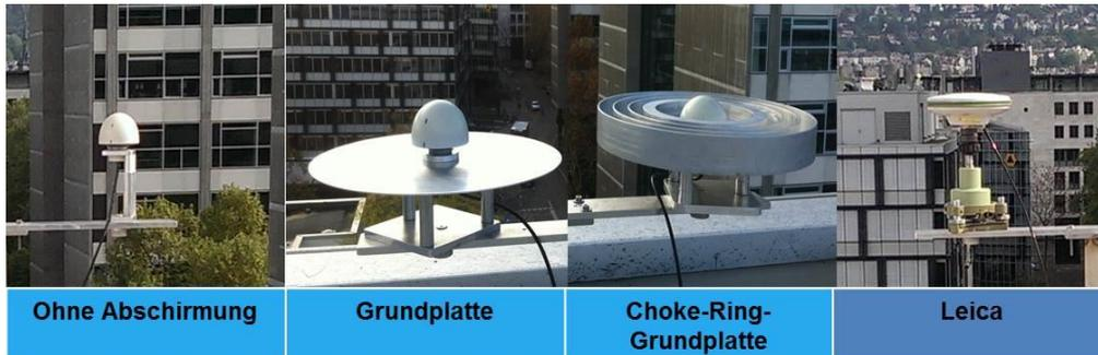
Abb. 5.7: Vier Varianten der Antennen-Abschirmung
