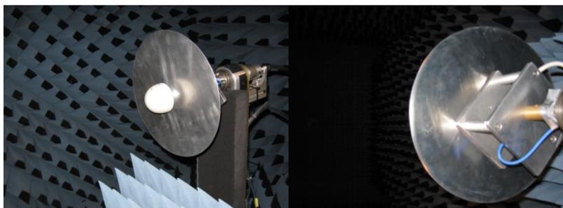
Abb. 5.3: Kalibrierung der TBIII-Antenne mit Grundplatte (Uni Bonn 2013a)
