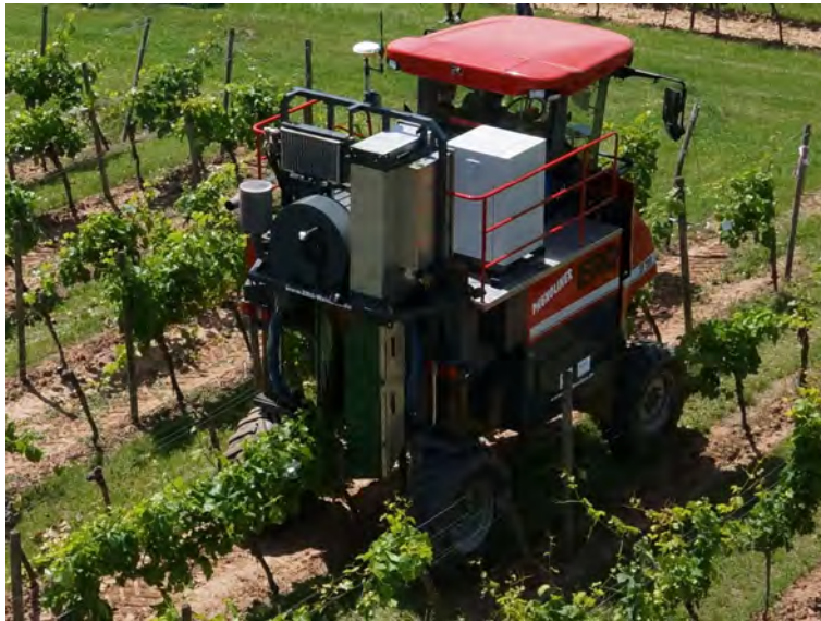
Abbildung 5.6: Der Phenoliner im Einsatz. Die Weinreben befinden sich im Tunnel, das Multi-Kamerasystem wird seitlich durch die Anbaureihen bewegt. Bildautor: Vine Xpert Digitaler-Weinbau GmbH.
