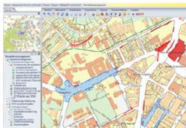
Koordinierung der einzelnen Baumaßnahmen
