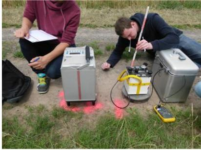
**RELATIVGRAVIMETRISCHE VERMESSUNG ENTLANG DES SCHWEREPROFILS MIT DEN INSTRUMENTEN SCINTREX CG3M-4492 UND LCR G79**
