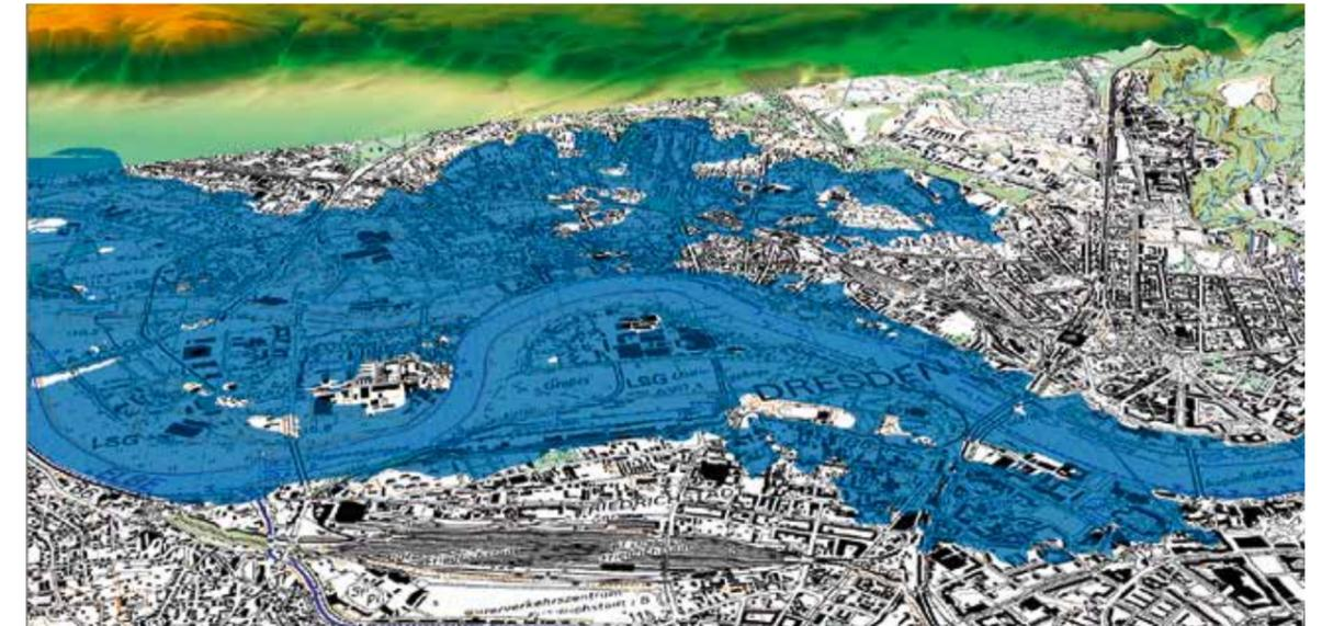
Die Abbildung zeigt anhand eines digitalen Geländemodells die Simulation von Hochwasser beispielhaft für Dresden.
