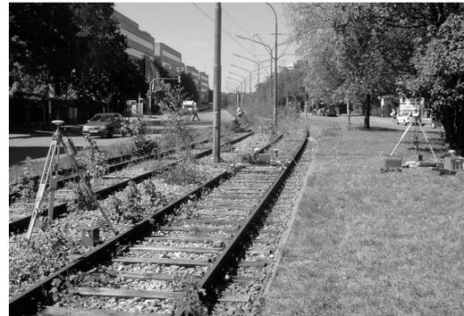
Abbildung 5.7: Schienensystem zur Kalibrierung des Gesamtsystems (München Boschetsrieder Str.)
