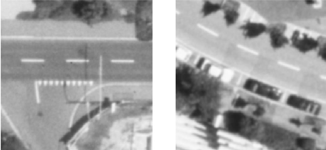
**Abbildung 6.** Detailerkennbarkeit: Markierungen und Fahrzeuge bei einer Bodenpixelgröße von 14cm ; auch Teilobjekte von Fahrzeugen werden abgebildet (Dach, Windschutzscheibe, etc.)
