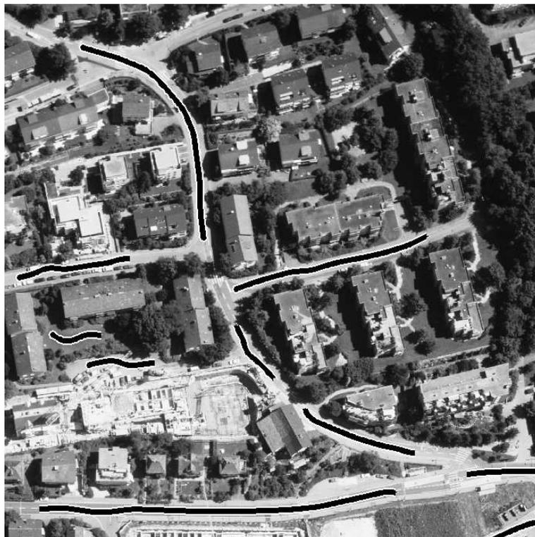
Abbildung 59. Extrahierte Fahrbahnen eines größeren Bildausschnittes.
