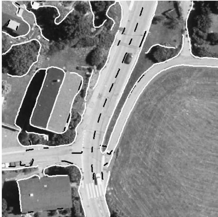
**Abbildung 12.** Extraktion von Kanten in einem auflösungsreduzierten Bild (weiß, siehe auch Abbildung 10) und von dünnen hellen Linien in einer hohen Auflösung von 15cm (schwarz)
