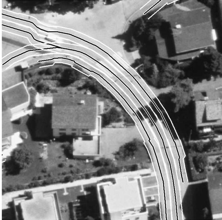
**Abbildung 54.** Vereinfachte Fahrspurcluster: Im Vergleich zur Fahrspurgruppierung (Abbildung 49) konnten nun Unterbrechungen in der rechten äußeren Spur der Hauptstraße (durch Schatten) und im Bereich der beiden Zebrastreifen überbrückt werden.
