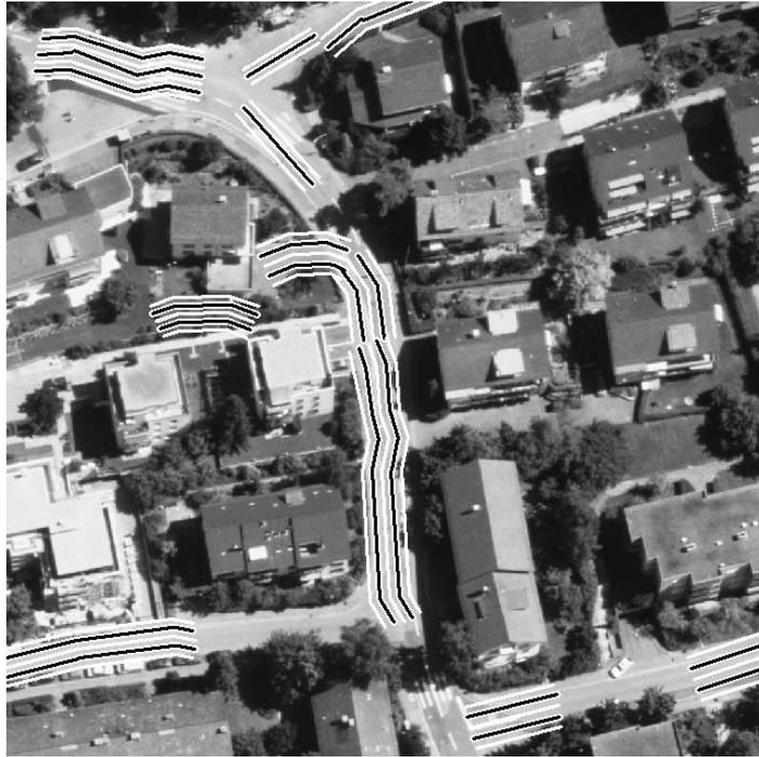
Abbildung 46. Extraktion von Fahrspuren auf Basis vorläufiger Straßenabschnitte.
