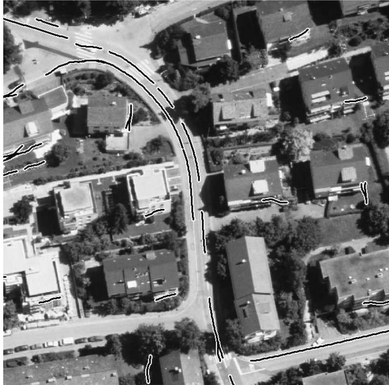
Abbildung 40. Ergebnisse für durchgezogene und strichlierte Markierungen.
