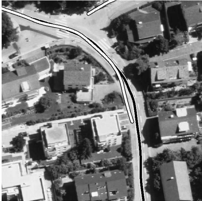
**Abbildung 63.** Überlagerung der Achsen von Fahrbahnen aus verschiedenen Bildern. Lageabweichungen der Fahrbahnen können größer als eine halbe Fahrspurweite sein, so dass eine eindeutige Zuordnung von Fahrspuren nicht unbedingt gewährleistet ist.
