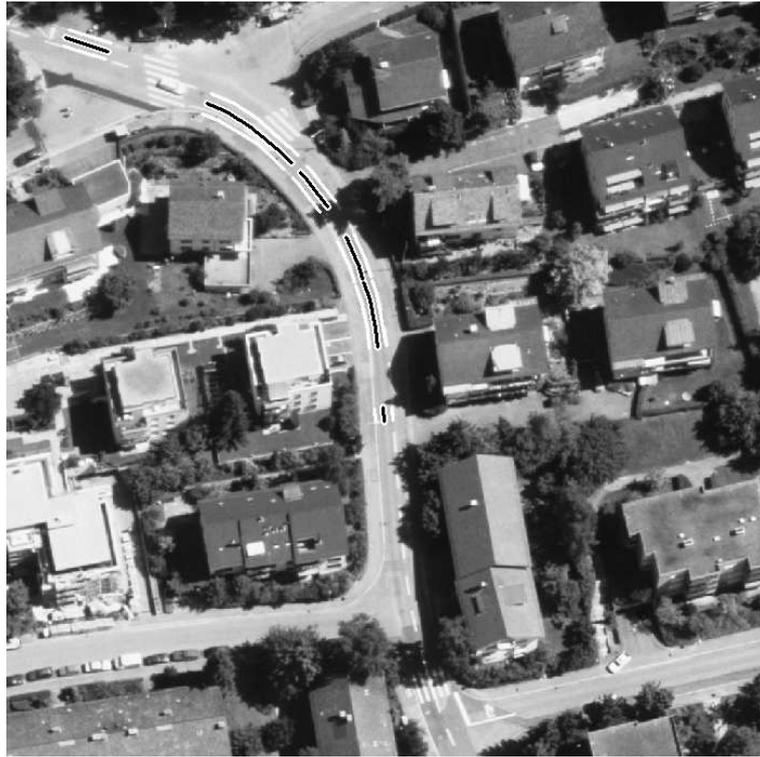
Abbildung 44. Extraktion von Fahrspuren aus parallelen Markierungen.
