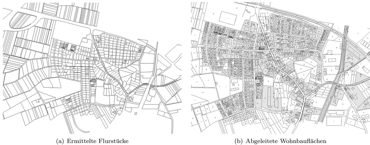
Abbildung 2.12: Ergebnis der automatischen ALK-Daten-Auswertung
