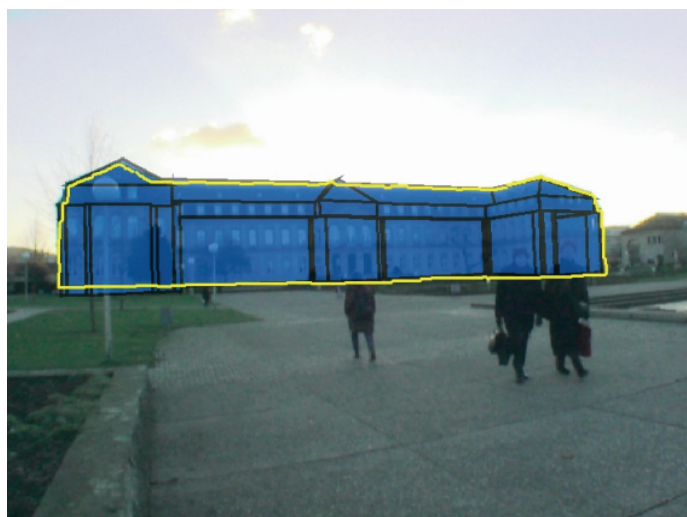
c) Lokalisierte Silhouette und Projektion des Gebäudes basierend auf verbesserten Orientierungsparametern
