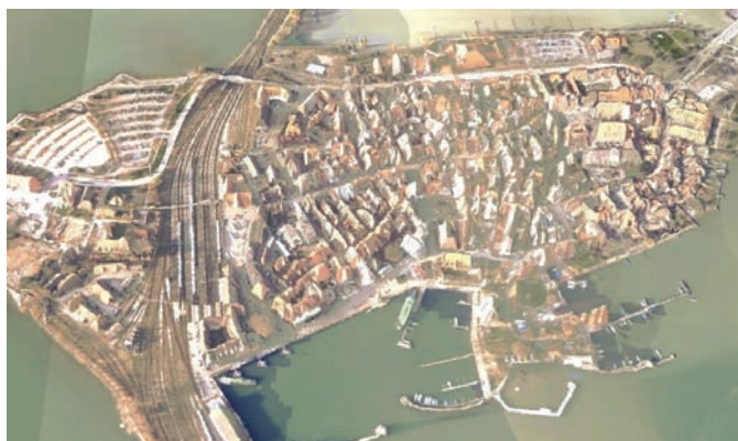
a) Visualisierung der Stadt Lindau aus der Vogelperspektive mit Entfernung über 200m. Erstellt durch Überlagerung von DOM-Daten mit Luftbildtextur.
