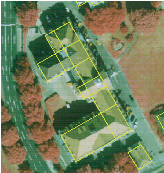
Abbildung 4-14: Rechteckzerlegung des Grundrisses.
