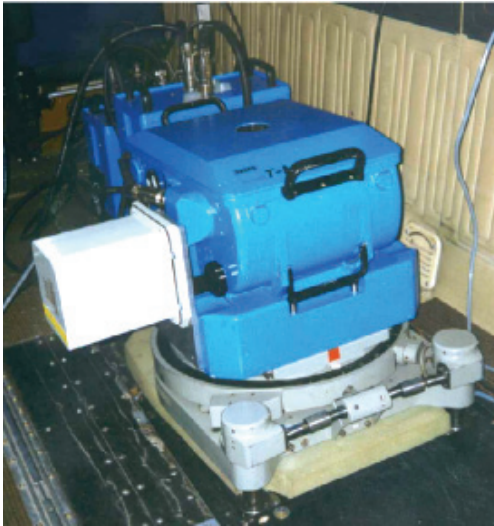
Abbildung 2-5 Inertiales Meßsystem und Luftbildkamera.
