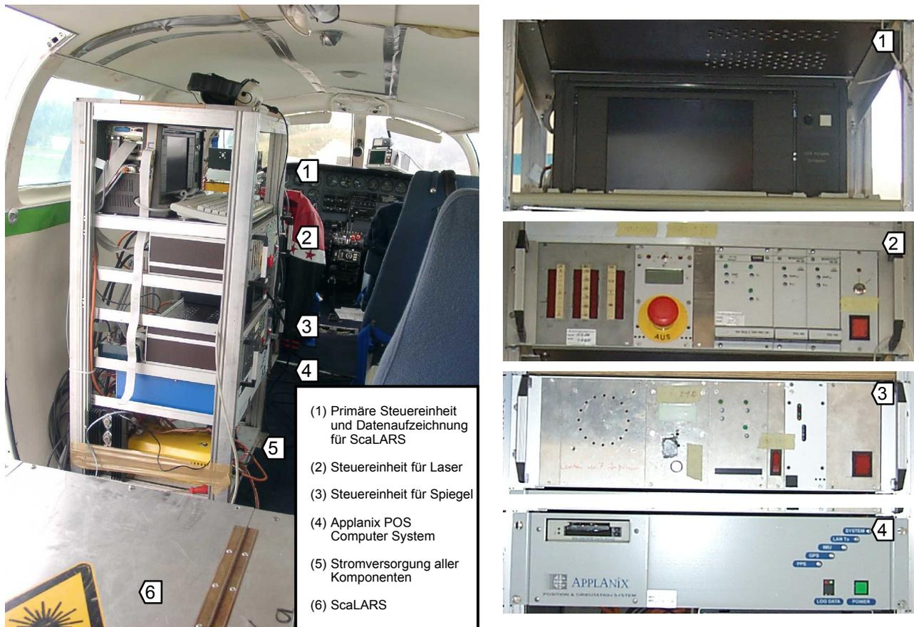
Abbildung 7.2: Aufbau des Messsystems mit Blickrichtung vom Heck zum Cockpit sowie in Frontansicht
