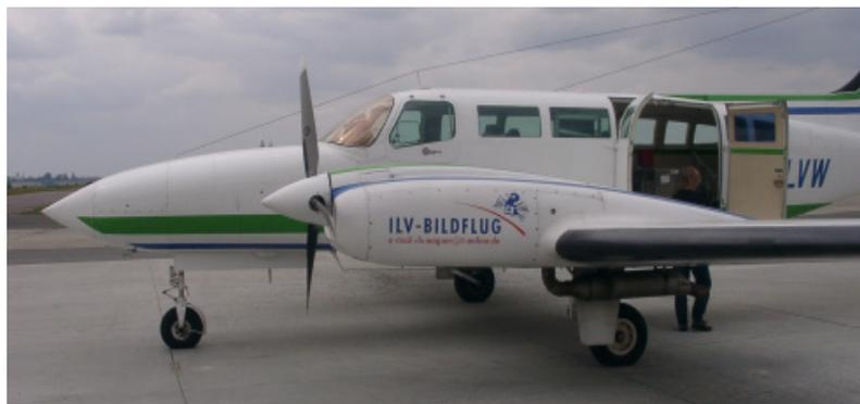
Abbildung 7.1: Trägerflugzeug Cessna 404 Titan Freighter
