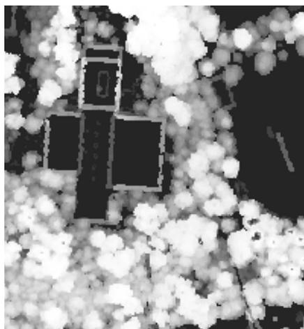
Abb. 22: Grauwertcodiertes Differenzbild, entstanden aus Subtraktion des Last-Echo vom First-Echo-DOM; je heller Pixel sind, desto höher ist die Differenz an dieser Stelle
