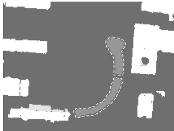
Abb. 19: Ergebnis der Objektsegmentation für die Szene aus Abb. 18, die Erdwälle sind wiederum gestrichelt markiert
