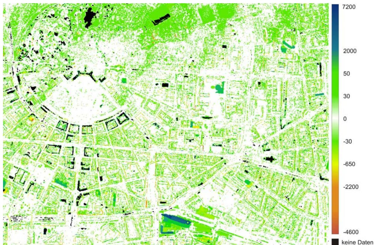
Abb. 92: Farbkodierte Darstellung der Differenzen zwischen den LE-DOMs von 1998 und 2002 (ca. 2 km x 1,6 km, Skala in cm)
