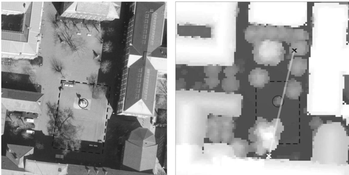
Abb. 14: Luftbild (links) und Ausschnitt aus einem First-Echo-DOM (rechts); Beispiele zur Objektüberlagerung u. a. auf einem Podium (gestrichelt umrandet) durch eine Statue (Kreis)
