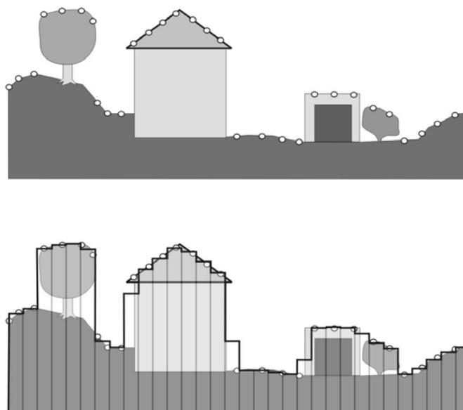
Abb. 8: Schematische Darstellung zur DOM-Erzeugung; oben: Originalszene mit Laserscanning-Messpunkten (Kreise); unten: DOM (schwarz umrandet) aus Interpolation der Höhenwerte auf überlagertem regelmäßigem Gitter
