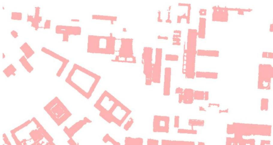
Abb. 81: Gebäudesegmente, segmentiert aus einem Last-Echo-Datensatz von 1998
