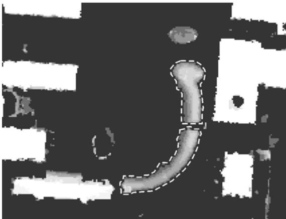
Abb. 18: Ausschnitt aus einem nDOM, basierend auf Last-Echo-Daten; die beiden gestrichelt umrandeten Objekte sind Erdwälle
