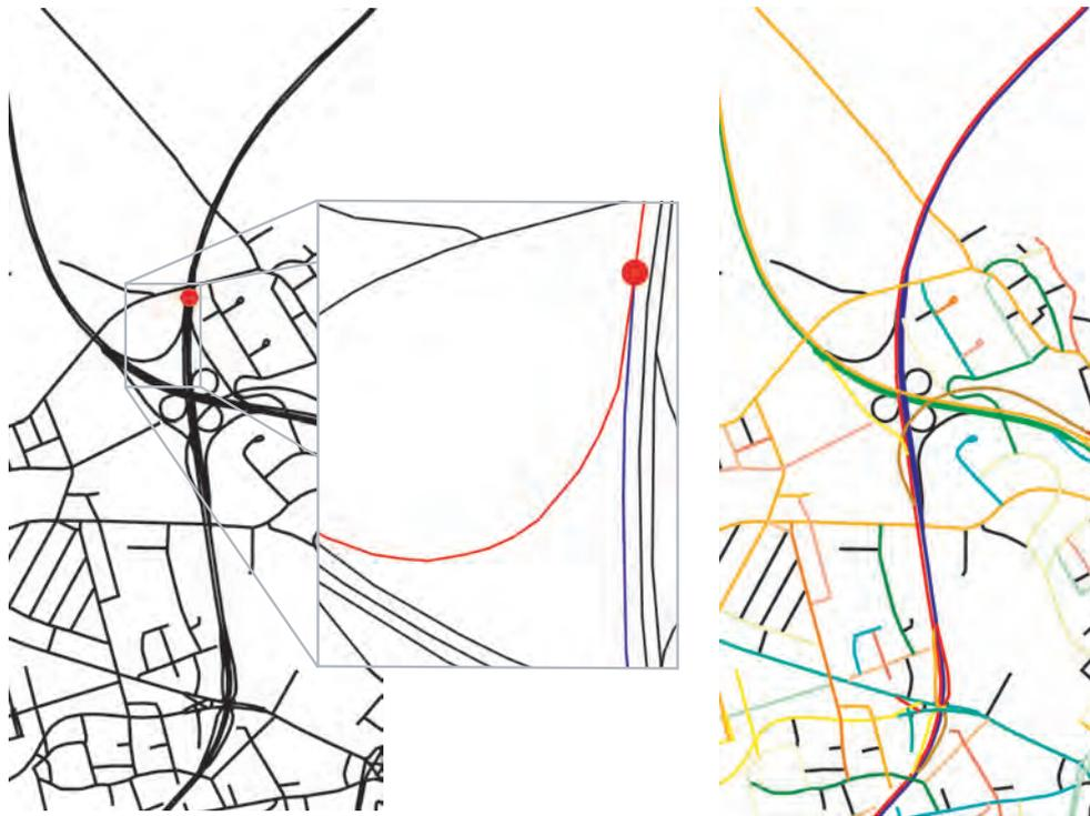
Abbildung 5.20: Strokeverfolgung an einer Autobahnabfahrt - durch Berücksichtigung der Krümmung der Straßenabschnitte am Knoten werden Fehlinterpretationen vermieden (rechts: Ergebnis des verbesserten Algorithmus)
