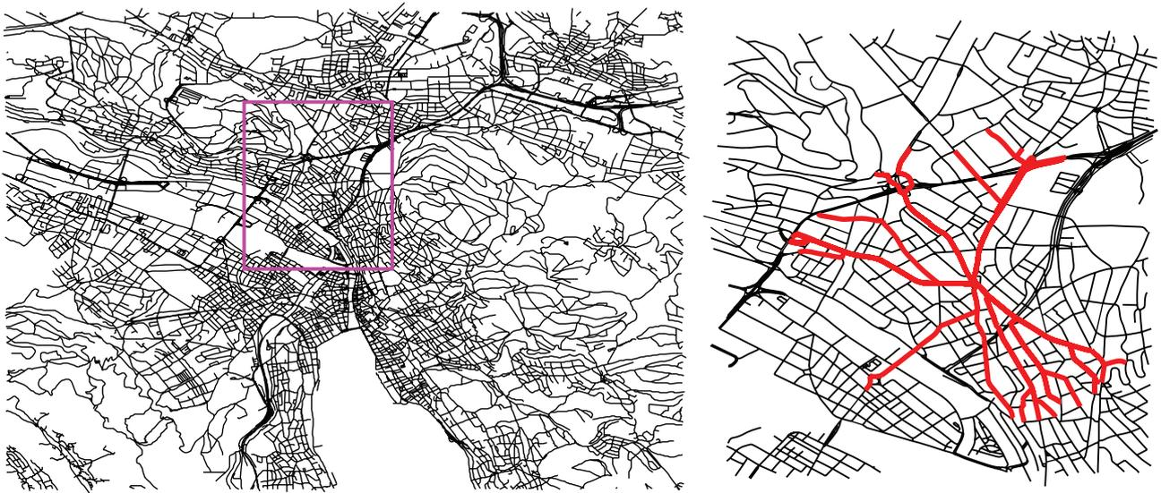
Abbildung 6.38: Beispiel zur automatischen Detektion kleinräumiger Sternstrukturen durch Festlegung eines geeigneten Suchradius
