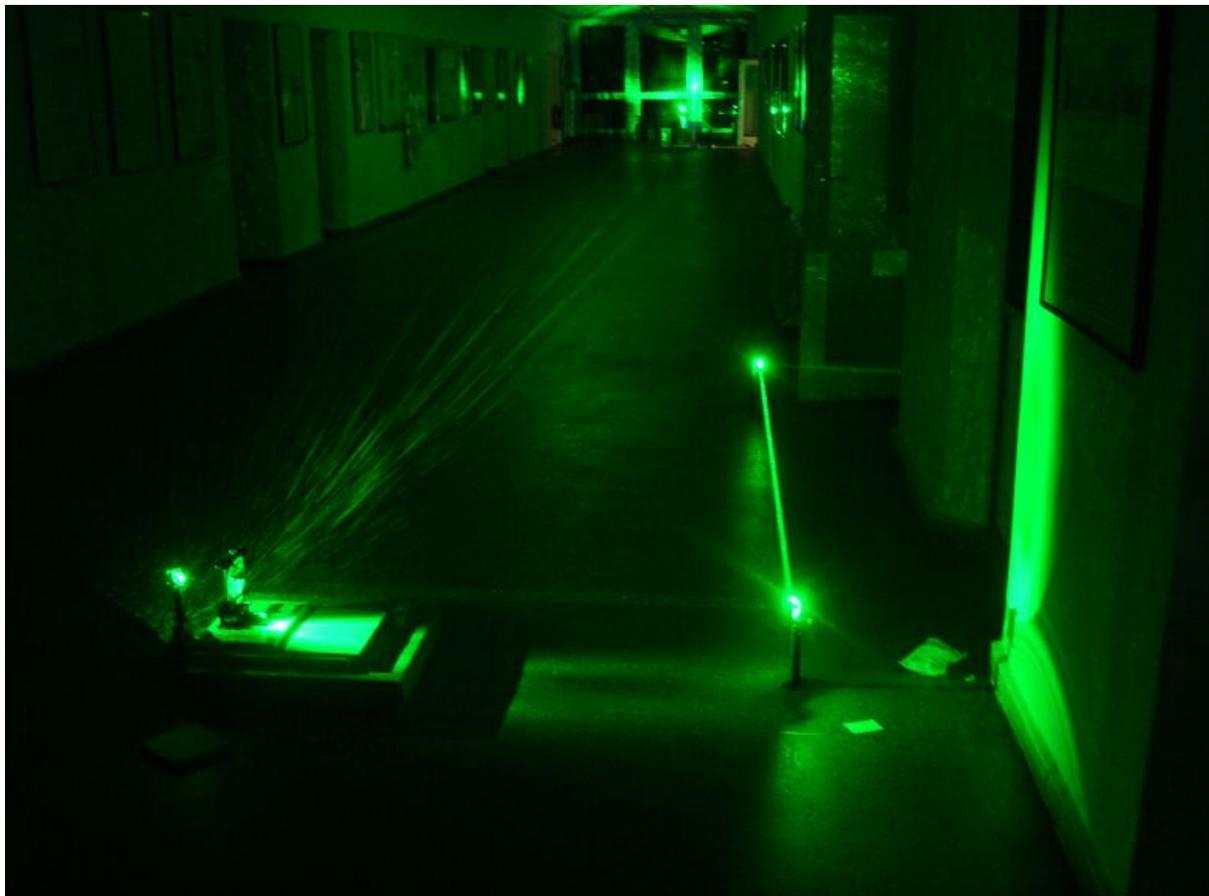
Abb. 8.21 : Messung auf der Vergleichsstrecke mit t-Pulse 500
