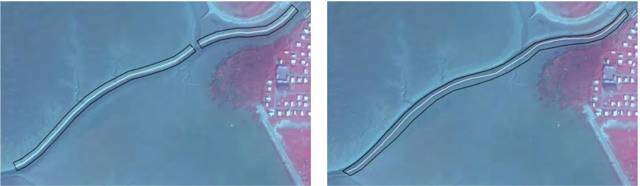
**Abbildung 5.23:** Befliegung „Außenweser 2004“ – Näherungslösung sowie Umringspolygon für die nördliche (links) und südliche Böschung (rechts). Die Mittelachsen sind in weiß und die Umringe in schwarz dargestellt.
