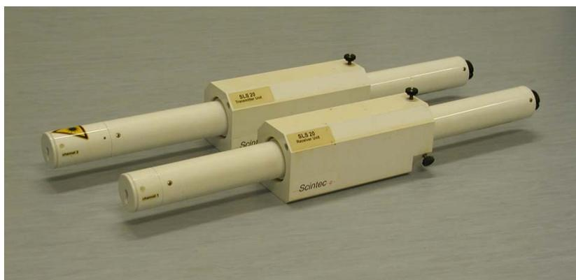
Abbildung 5.1: Szintillometer SLS 20; hinten: Laseremitter, vorne: Receiver.
