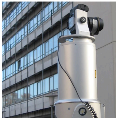
Abb. 7.1: Terrestrischer Laserscanner während der Erfassung von Testdaten.
