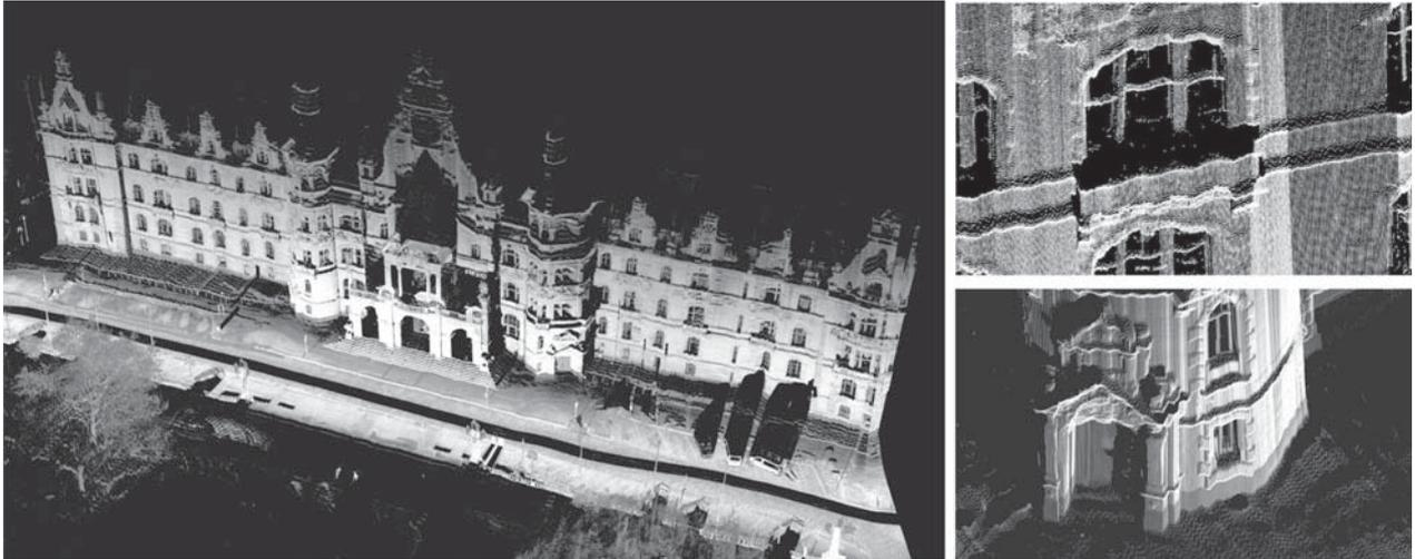
Abbildung 7.14: Szene Hannover Neues Rathaus - Gesamtansicht (links) und Detailansichten der Fassade (rechts) - Punktwolke berechnet mittels kombinierter kinematischer Georeferenzierung
