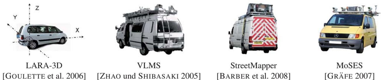
Abbildung 2.4: Exemplarische Mobile-Mapping-Systeme mit Georeferenzierung
