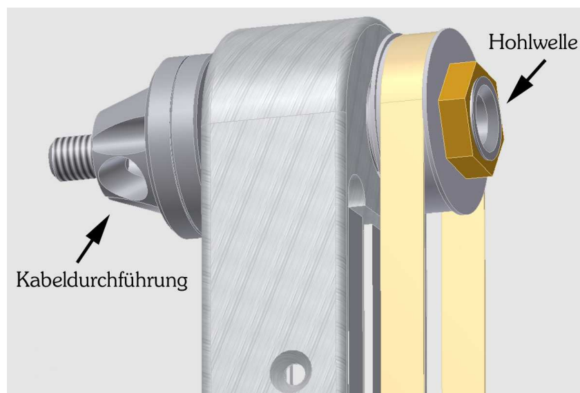
Abb. 8.22: Azimutachse des Drehstandes mit Hohlwelle zur Kabeldurchführung.
