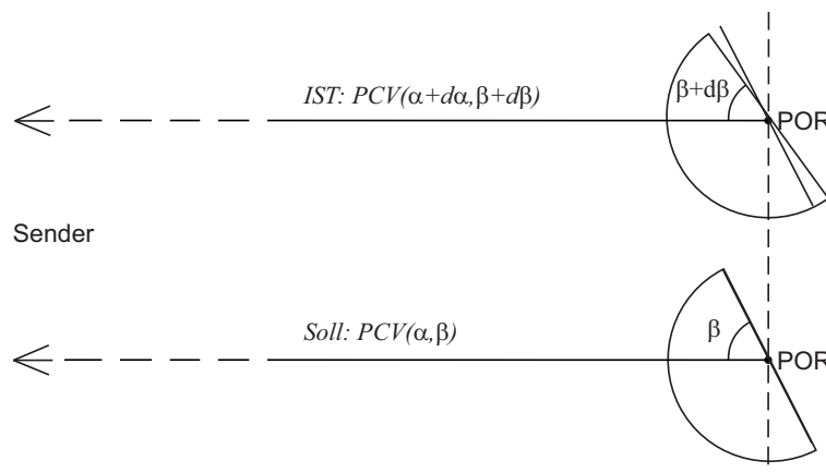
Abb. 8.17: Einfluss der Positioniergenauigkeit auf die Abtastung richtungsabhängiger Phasenvariationen.
