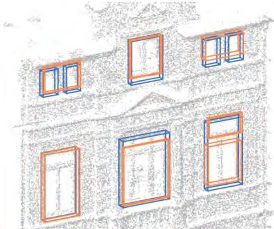
Abbildung 4.13: Beispiel für Fehlerquellen der Rekonstruktion: „doppelte“ (oben links und rechts) und „halbe“ (unten rechts) Fenster: automatisch, iterativ rekonstruierte Fenster (orange) sowie die manuell ermittelten Objekte (blau)
