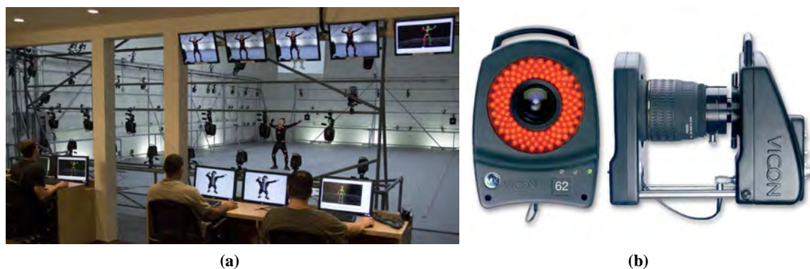
Abb. 12.9: Motion Capturing Studio : (a) Studioumgebung zur vollständigen Körper- und Bewegungserfassung (Vicon House of Moves, Inc. 2008). (b) NIR-Megapixelkamera zur Erfassung retroreflektierender Positionsmarker (Inition: Everything in 3D 2011).
