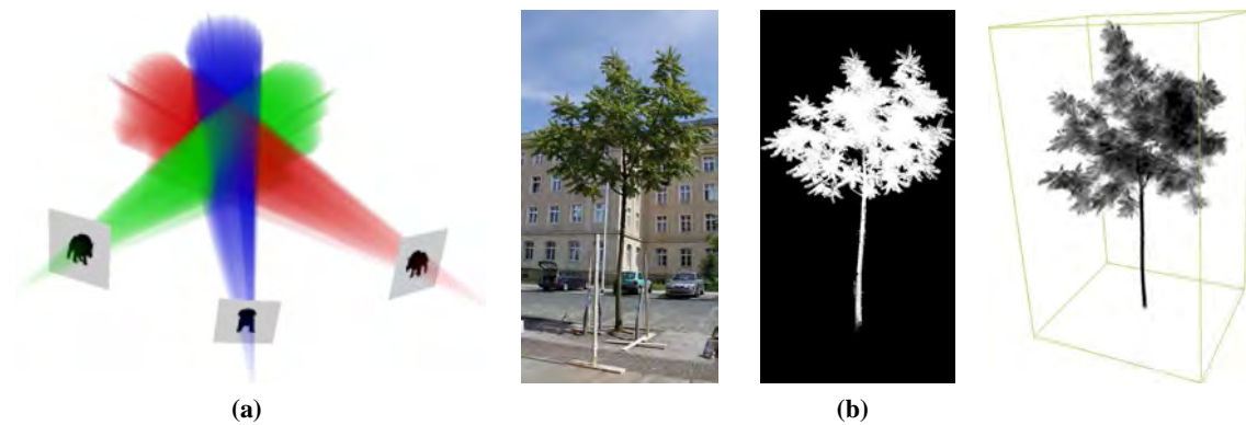
Abb. 6.7: (a) Prinzip des Silhouettenschnittverfahrens (Buehler u. a. 1999): Die Schnittpunkte der drei Konen definieren die visuelle Hülle des Objekts. (b) Volumetrische Rekonstruktion eines Baums (Vock u. a. 2010): Aufnahme eines Mehrbildverbands (links). Das entsprechend nach Vorder- und Hintergrundzugehörigkeit in eine Grautonskala segmentierte Eingabebild (Mitte). Beispiel eines rekonstruierten Baums (rechts).
