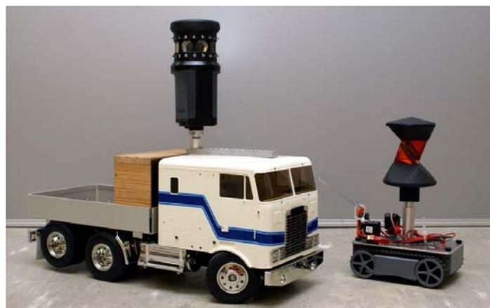
Abbildung 66: Fahrzeugmodelle im Baumaschinensimulator des IIGS (links Radfahrzeug, rechts Raupenfahrzeug)
