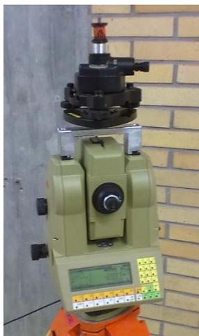
Abbildung 65: Aufbau der Prismen zur Überprüfung der systematischen Effekte bei Reflektoren
