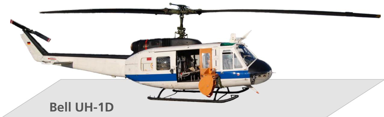
Abbildung 5.1: Hubschrauber mit seitlich angebrachter Sensorplattform (orange).
