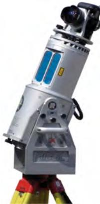
Abbildung 4.4: Laserscanner Riegl LMS-Z420i (Riegl, 2009).
