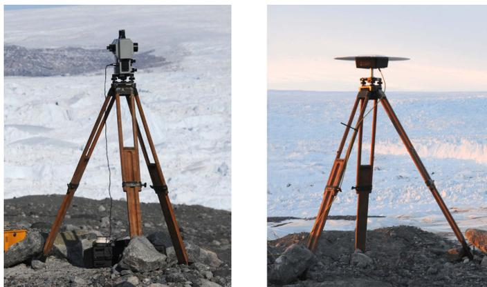
**Abbildung 3.11: Tachymeteraufstellung (links) und GPS-Messung (rechts) auf einem Basislinienendpunkt.**
