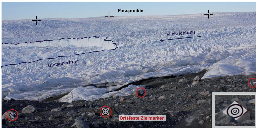
**Abbildung 3.9: Messbild.** Die Abbildung zeigt eine Aufnahme der Sequenzkamera. Im Messbild müssen ortsfeste Zielmarken sowie Höhenpasspunkte sichtbar sein. In der rechten unteren Bildecke ist eine der Zielmarken vergrößert abgebildet.
