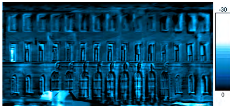
Abbildung 6.19: Differenztextur der Abkühlung über die Nacht. Skala angegeben in Grad Celsius, berechnet aus den Grauwerten der Texturen und der radiometrischen Korrektur der Kamera
