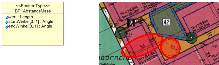
Abbildung 27: neue Objektart BP_AbstandsMass in XPlanGML 4.0, Falluntersuchung Abstandsmaße (rechts) (Müller & Würriehausen, 2013a)
