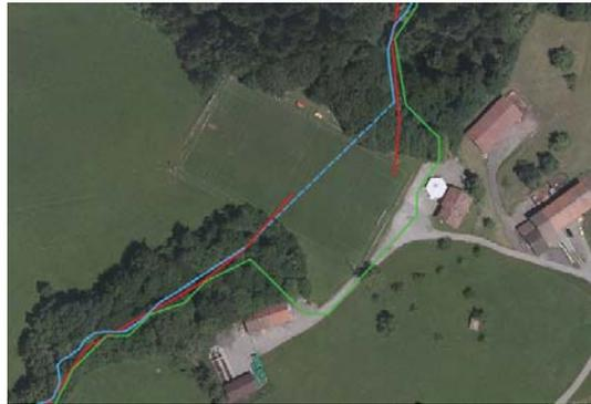
**Abbildung 6.17.:** Das Gewässernetz (blau) verläuft im Bereich eines Fußballplatzes unterirdisch in Rohren. Der *Flow Routing*-Ansatz (grün) bestimmt dann einen alternativen Verlauf des Wassers auf Grundlage der Geländeneigung im DGM. Im Ergebnis des *Forest Point Process* (rot) ist in diesem Bereich das Gewässernetz unterbrochen.
