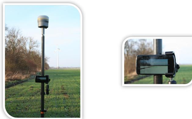
*Abbildung 7.19: Gekoppelte GeoARS mit Verwendung eines präzisen GNSS-Empfängers (hier: geodätischer Empfänger Trimble R10)*
