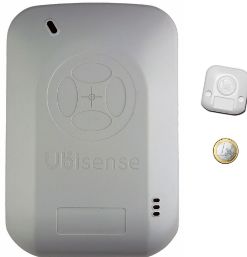
Abbildung 3.3.: UWB-Sensor und UWB-Tag im Größenvergleich [Ubisense, 2012]
