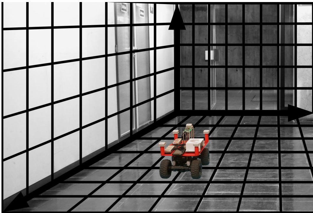
Abbildung 1.2.: Sensorplattform innerhalb eines lokalen Koordinatensystems
