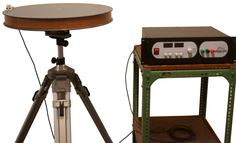
Abbildung 3.10.: Magnetpule und Umschaltnetzteil des Positionierungssystems MILPS
