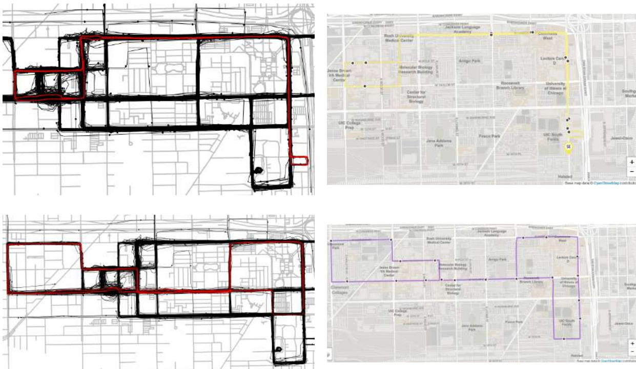
Abbildung 7.20: Ein Vergleich der erkannten Muster mit der Realität: In der linken Spalte werden die erkannten Bewegungsmuster der Busse dargestellt, in der Rechten die offiziellen Routen der Buslinien 3 .
