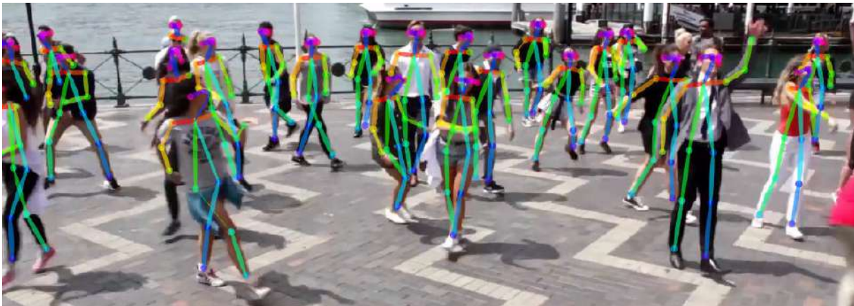
Abbildung 8.1: Zur Detektion der Objekte in Bildern können auch Deep Learning-Verfahren genutzt werden: bspw. der Ansatz nach Cao u. a. (2016) (gleichzeitig auch Bildquelle), der Skelette in die erkannten Personen schätzt.
