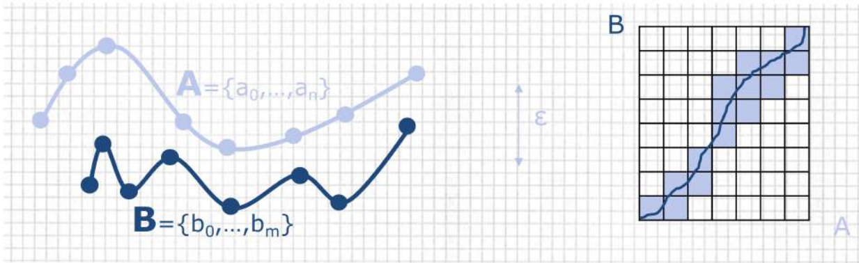
Abbildung 2.18: Schematische Darstellung der Berechnung der Fréchet-Distanz: Die Beispieltrajektorien A und B (links), der kritische Abstand \epsilon (Mitte) und die entsprechende Darstellung als Free-Space-Diagramm (rechts).
