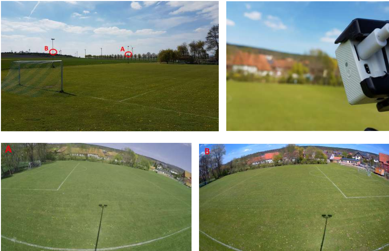
Abbildung 6.8: Das Kamera-Setup für das Fußballanalyse-Experiment besteht aus zwei Kameras (A, B), deren Sichtfelder das Spielfeld nahezu komplett abdecken (inkl. Überlappung in der Mitte des Spielfelds).
