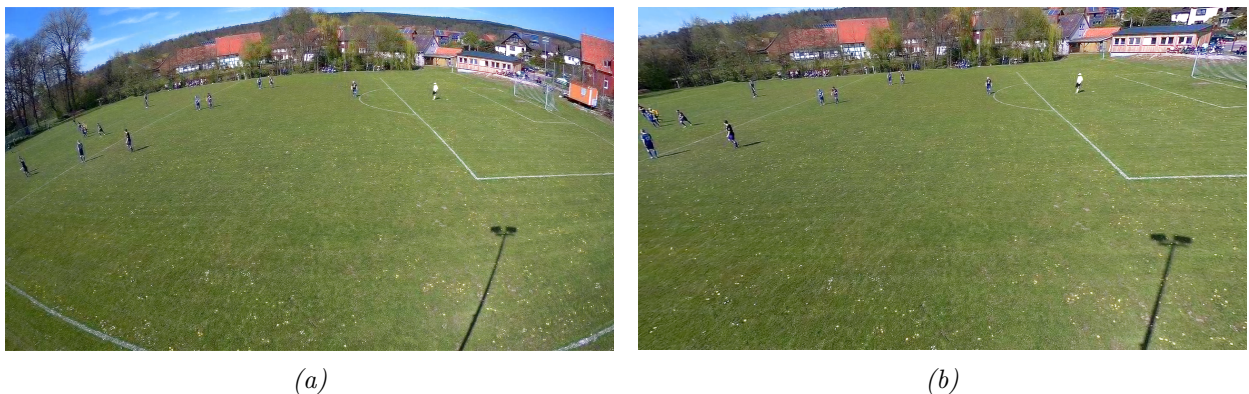
Abbildung 6.3: Die Kamerabilder müssen zu Beginn entzerrt werden. Das Bild vor (a) und nach (b) der Korrektur.
