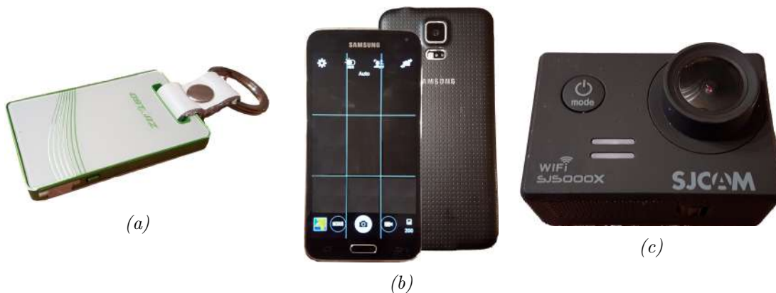
Abbildung 6.2: Die in den Experimenten verwendeten Sensoren: a) der QSTARZ BT-Q1300ST GPS-Logger, b) das Samsung Galaxy S5 Smartphone als Smart-Kamera und c) die SJCAM SJ 5000x Elite Action Cam.
