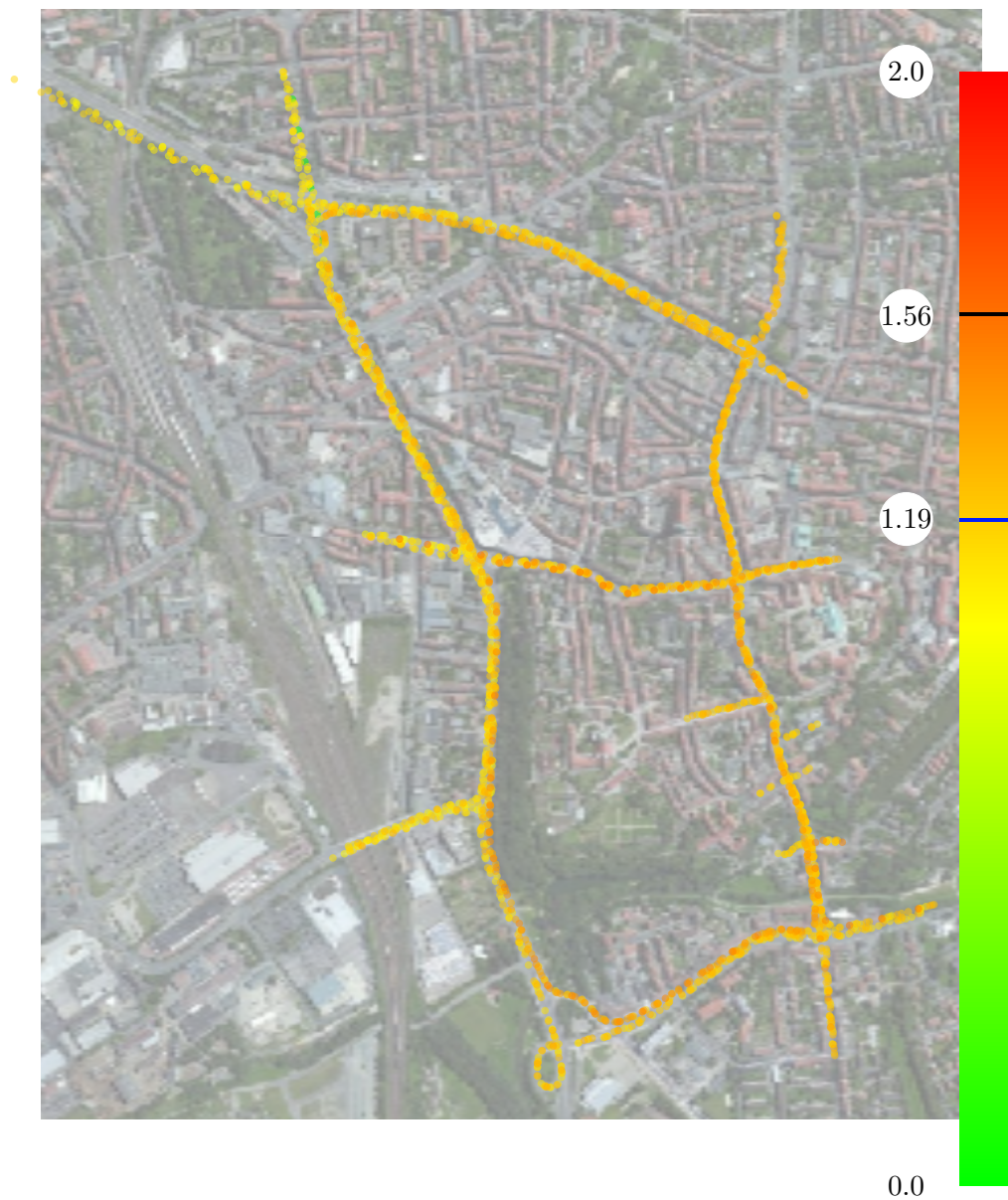
Abbildung C.2.: RMS Positionierungsfehler (Ausgabe des Systems von Applanix) in den Egotrajektorien der 2. Stufe: GNSS (GAMS) + IMU + DMI. Die Farbskala beschreibt den Fehler in Metern. Die blaue Markierung markiert den durchschnittlichen Fehler, die schwarze den maximalen.
