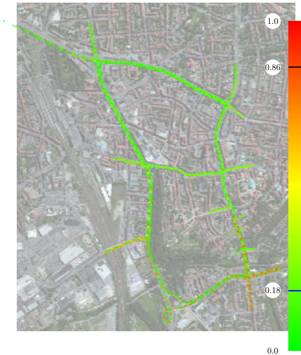
Abbildung C.3.: RMS Positionierungsfehler (Ausgabe des Systems von Applanix) in den Egotrajektorien der 3. Stufe: GNSS (GAMS) + IMU + DMI + SAPOS. Die Farbskala beschreibt den Fehler in Metern. Die blaue Markierung markiert den durchschnittlichen Fehler, die schwarze den maximalen.
