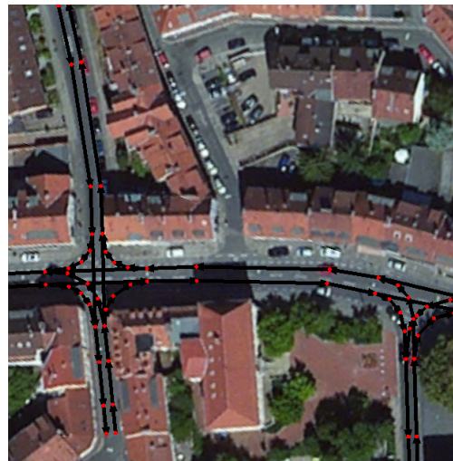
(b) Repräsentation eines Straßennetzes als fahrspurgenauer Graph in Überlagerung zu einem Satellitenbild (Quelle: Microsoft Bing). Knoten sind in Rot und Kanten in Schwarz dargestellt.
