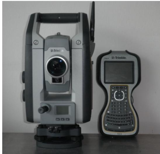
Abbildung 4-2: Trimble S7 Total Station mit mobilem Handgerät TSC3
