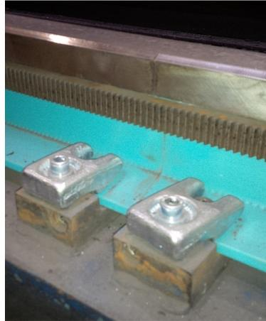
**Abbildung 6.13:** Schiene mit rechteckig gefrästem Kopf, Fasen, Zahnstange im Steg, rechtwinkligem Stoß und Schienenbefestigung.
