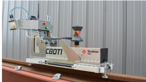
**Abbildung 2.29:** Kranbahnmesswagen CBOT1 (Strukton Rail Benelux, 2022).
