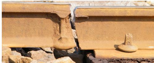
Abbildung 4.4: gebrochener Schienenstoß (Wikipedia, 2013)
