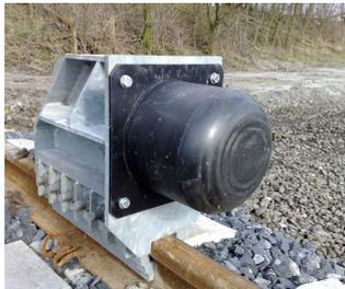
(a) Begrenzer mit Gummipuffer; auf der Schiene geklemmt (SM-Schientechnik GmbH (2017)).
