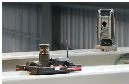
**Abbildung 2.26:** Kranbahnmesswagen RailQ™ und Tachymeter (Service, 2017).
