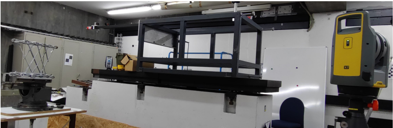
Abb. 4.5: Testsetup für den Vergleich der unterschiedlichen Laserscanner.
