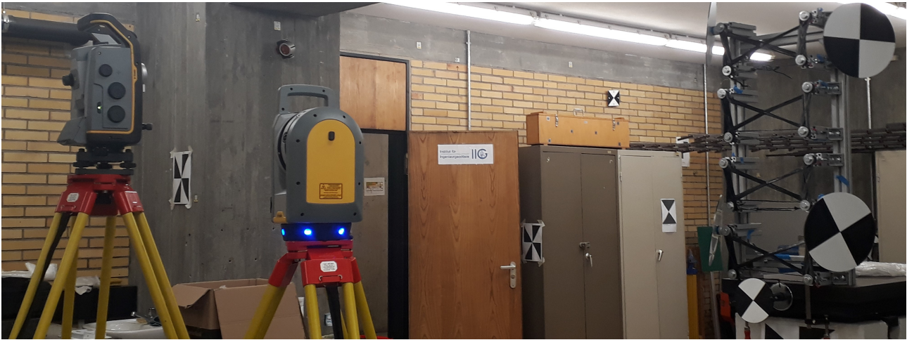
Abb. 5.5: Messaufbau für die Testdatensätze unterschiedlicher Komplexität für die TLS-Messungen, sowie die tachymetrischen Messungen. Die Abbildung zeigt dabei den Aufbau für das Testobjekt S1.
