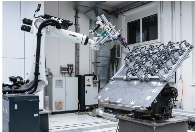
Abb. 5.4: Fertigungssetup der Testdatensätze unterschiedlicher Komplexität. Dabei sind die montierten Fertigungsrahmen auf dem Kipptisch, sowie die Ausrichtung des Roboters zum Kipptisch dargestellt (Gil Pérez et al. 2022).
