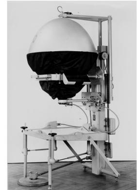
Bild 11: Entzerrungsgerät SEG IV
