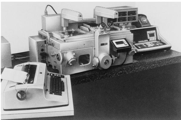
Bild 47: Steko 1818 mit Registrier- und Speicherperipherie der C.Z. Scientific Instruments Ltd. London
