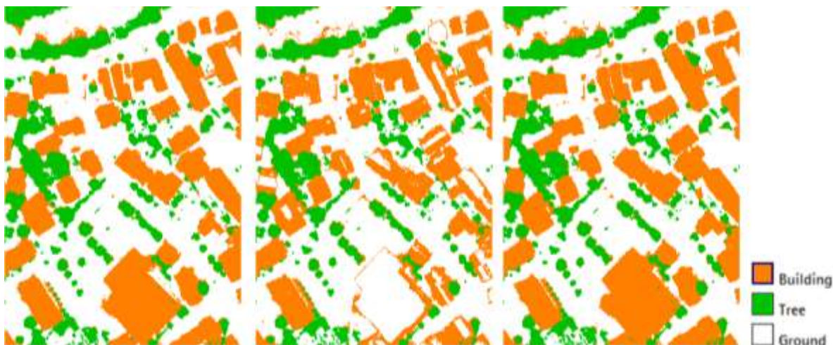
Abb: Exemplarische Klassifikationsergebnisse: Klassifikator trainiert und angewendet auf Zieldomäne ohne Transfer-Lernen (bestmögliches Ergebnis mit dem verwendeten Klassifikator) (Bild links); Klassifikator trainiert auf Quelldomäne und angewendet auf Zieldomäne ohne Transfer-Lernen (Ausgangssituation für Transfer-Lernen) (Bild Mitte); Klassifikationsergebnis nach Transfer-Lernen (Bild rechts). (getestet auf: Potsdam Data Set aus dem ISPRS 2D Semantic Labelling Contest)
