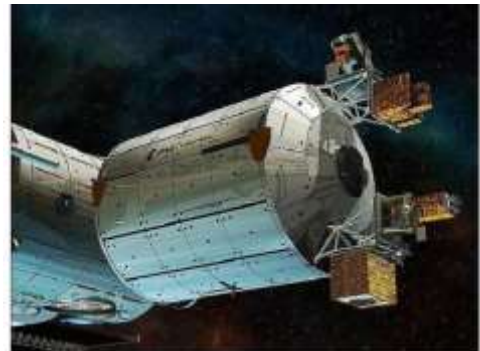
Abb. Columbus Modul der ESA an der Internationalen Raumstation. Unten rechts, montiert außerhalb des Moduls, befindet sich das Atomic Clock Ensemble in Space (ESA).
