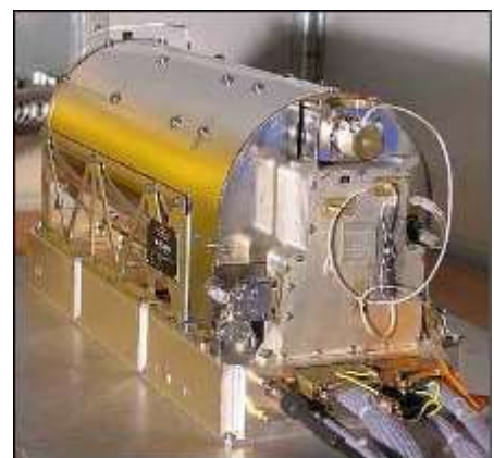
Abb. Passiver Wasserstoffmaser der Galileo Satelliten (ESA)
