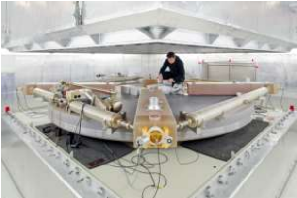
Abb. Großringlaser am Geodätischen Observatorium Wettzell, der als hochstabile optische Lichtquelle genutzt und über neu entwickelte Interfaces gegenüber einem Wasserstoffmaser vermessen wurde
