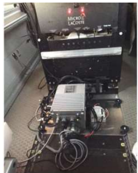
Abb. Fluggravimetrie-Vergleichsmessungen in Texas und Colorado: iMAR iNAV-RQH 1003 (vorne) und ein Micro-g/LaCoste TAGS Fluggravimeter (hinten)
