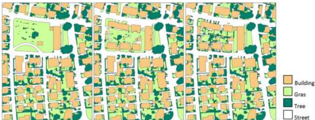
Abb. Beispiel für ein Klassifikationsergebnis: links: existierende Karte; Mitte: Ergebnis der automatischen Aktualisierung unter Verwendung der existierenden Karte zum Training; Rechts: manuell erstellte Referenz
