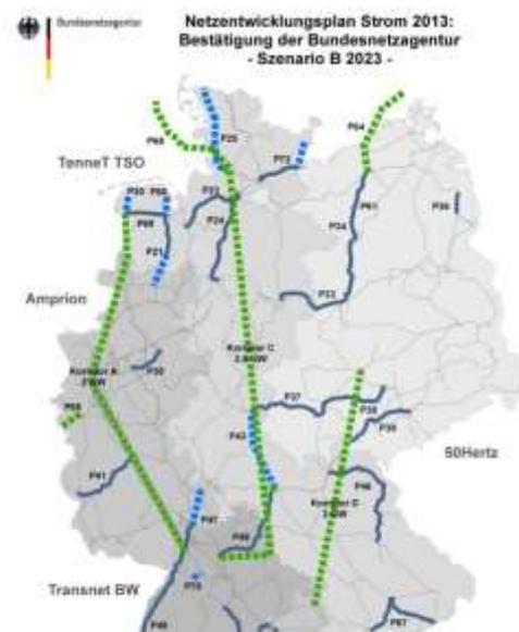
*Abb. Netzausbaubedarf, in grün-gestrichelt dargestellte Trassen sind als Erdkabel zu realisieren*
