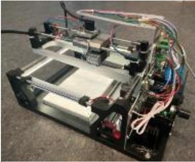
**Abb. 1:** Kreuzschlitten-Messsystem mit Kamera
