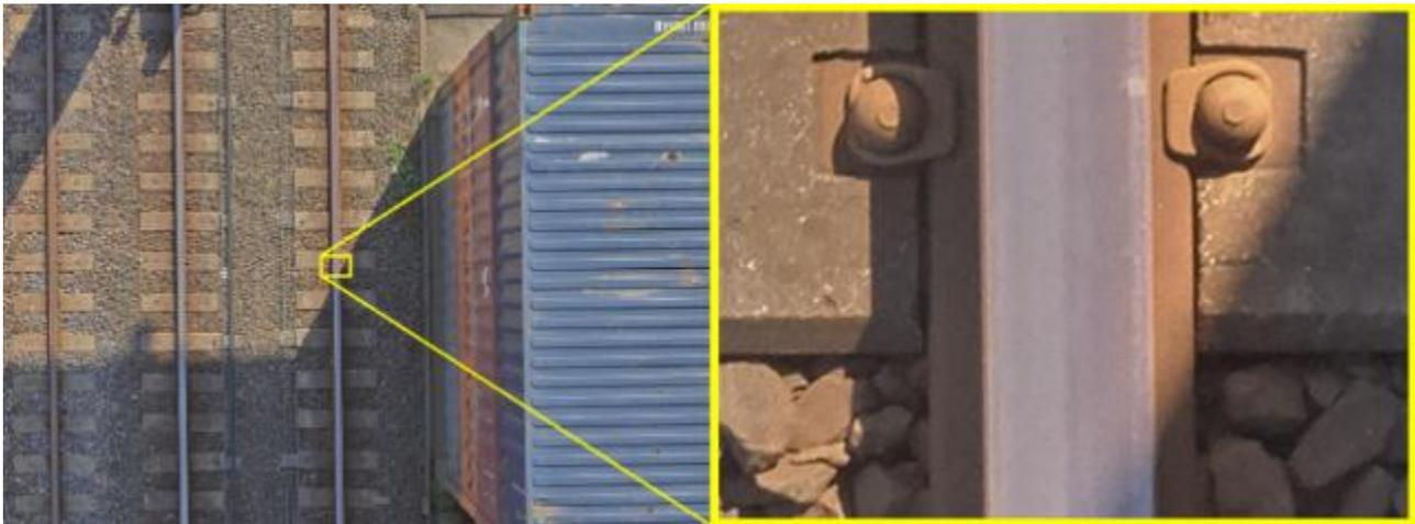
**Abb.** Volle Abdeckung eines Luftbildes aus 35m Höhe und Bildausschnitt (entspricht ca. 45x34cm, GSD 0,9mm)
