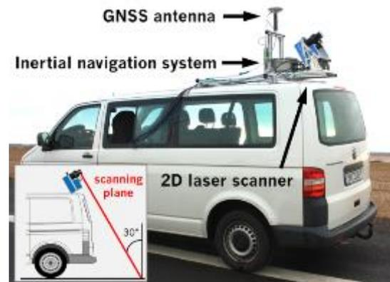
*Abb.: Mobile Laserscanning System*
