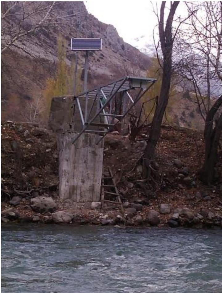
*Abb. Abflussmessstation in Usbekistan. Die Daten werden von den nationalen hydrologischen Diensten der Region für Wasservorhersagen genutzt*
